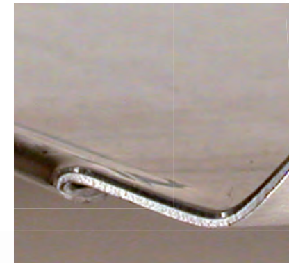
Stabilität durch Ankantung
