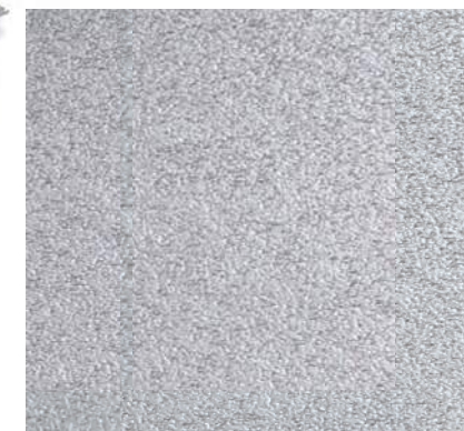
Рельефная структура уменьшает видимость царапин
