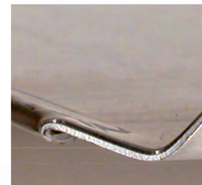
Стабильность благодаря отбортовке
